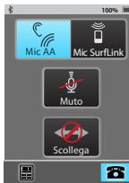
(4a) La funzione **JustTalk** (Mic AA) utilizza il microfono degli apparecchi acustici, mentre quella **Mic SurfLink** utilizza il microfono integrato nel SurfLink Mobile.
