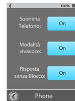
**Suoneria Telefono:** se attiva (On), questa funzione fa sì che lo squillo delle telefonate in arrivo sul cellulare venga trasmesso, tramite SurfLink Mobile, agli apparecchi acustici.
